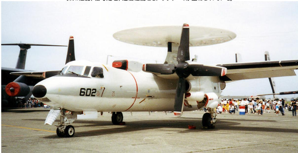
左側面 全長17.6m 全幅 24.6m 総重量 23.4トン 大きな機体である。
