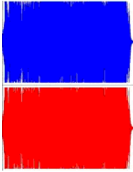
マスタリング後 (現代のダンス・ロックではこのような波形が多い)
