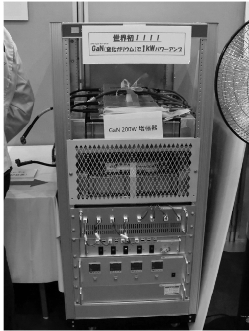
写真23・ベルチエ素子でガンガン冷やす
